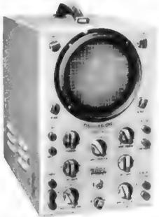
12,5-cm-Bildröhre mit Flutlichtrasterscheibe und kontinuierlicher Helligkeitsregelung, Strahlverschiebung horizontal und vertikal, Rücklaufaustastung, Helligkeitsmodulationsanschluß, Eichspannung, 50 Hz und Sägezahnabgang. Technische Daten: Vertikal: Gleichspannungs-Gegentaktverstärker 0-5 MHz (verwendbar bis 10 MHz) 10 mV/cm, 4fach frequenzkomp.
