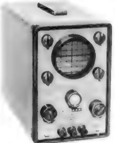
Klein-Oszillograph mit 7,5 cm Planschirmröhre, Rücklaufaustastung, Helligkeitsmodulationsanschluß (2 MOhm/25 pF), Astigmatismusregler, Mu-geschirmter Hals, 1500 V Beschleunigungsspannung, stabilisiertes Netzteil, Direktanschlußmöglichkeit der Vertikalplatten, besonders kleine Ausführung, Größe: 21,6x14,6x28,6 cm, Gewicht: ca. 5 kg
