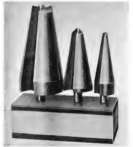
Der Schäl-Aufreiber wird in drei Größen geliefert, mit denen man Löcher bis zu 14 mm, 20 mm bzw. 30 mm herstellen kann. Beim Bohren sollte unbedingt ein geeignetes Kühl- und Gleitmittel verwendet werden
