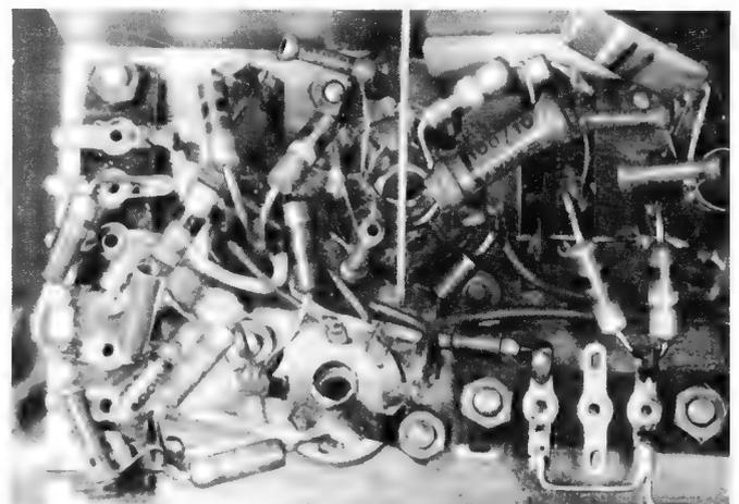
Bild 6. Die letzte Zf-Stufe und der Ratio-Detektor
