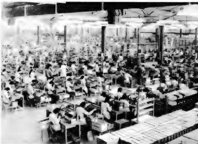
Links: Bild 1. Gesamtüberblick über die große zentrale Fertigungshalle in Le Mans. Die lichte Höhe der Halle beträgt fünf Meter; trotzdem ist die Beleuchtung ausreichend, so daß sich in Tischhöhe eine Lichtstärke von 400 Lux ergibt
