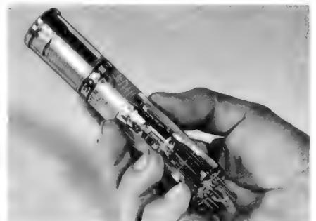
Bild 3. Vidicon-Bildaufnahmeröhre für Transistor-Kameras (EMI)
